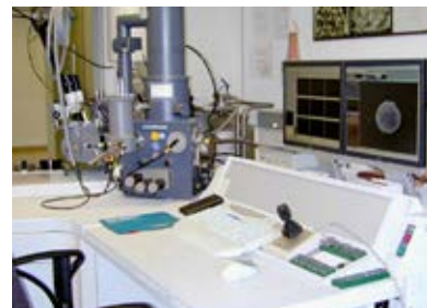
Différentes compétences scientifiques sont rassemblées au sein du WDI. Celui-ci dispose d'équipements d'essais et d'analyses physico-chimiques de pointe. Ci-dessus, microscopie électronique à balayage MEB (WDI)
