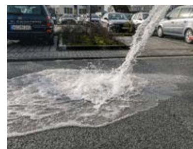
REWADUR – béton drainant carrossable (BÉTONS FEIDT / KARP KNEIP, IFSB)
